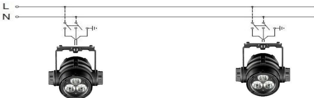
Quando alimentato dalla rete attraverso l'alimentatore esterno, il dispositivo deve essere collegato ad un sistema di alimentazione dotato di un'efficiente messa a terra. Inoltre, si consiglia di proteggere le linee di alimentazione dei prodotti dai contatti indiretti e/o da cortocircuiti verso massa utilizzando interruttori differenziali opportunamente dimensionati. Il collegamento alla rete elettrica deve essere effettuato da un installatore elettrotecnico qualificato.
