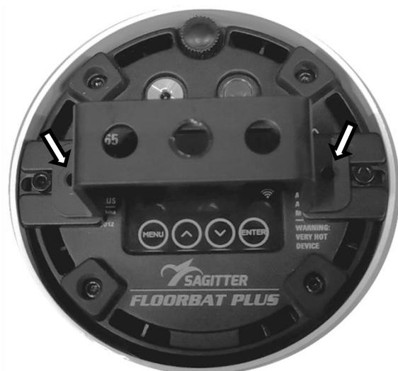
3. Posizionare la staffa pendant ed avitarla con le due viti a brugola M4x15 fornite in dotazione
