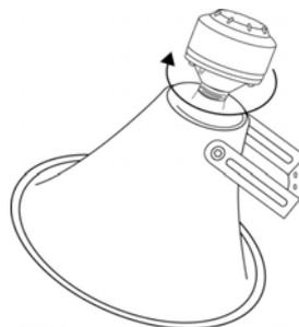
2. Ancorare saldamente la staffa di fissaggio nel punto in cui si desidera installare la tromba.
