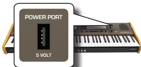
1. Conecte la lámpara LED flexible al PUERTO DE ALIMENTACIÓN.
