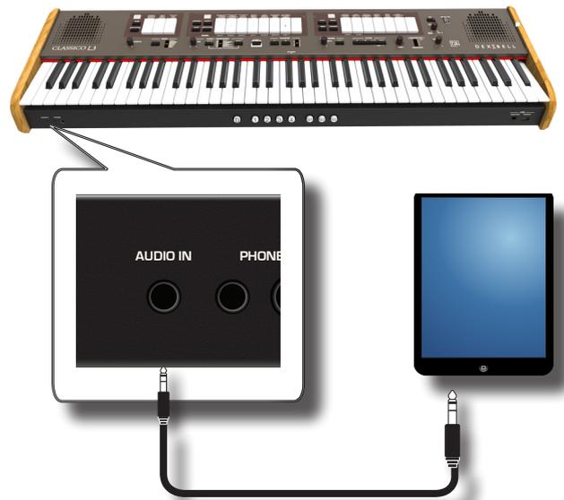
3. Use el mando AUDIO IN para ajustar el nivel de entrada de la toma AUDIO IN del CLASSICO L3 a la salida de la señal recibida .
